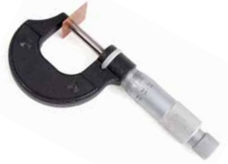
الشكل (3): قياس سُمْك صفيحة باستخدام الميكروميتر.
