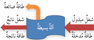
الشكل (14): تحولات الطاقة في الآلة البسيطة.
